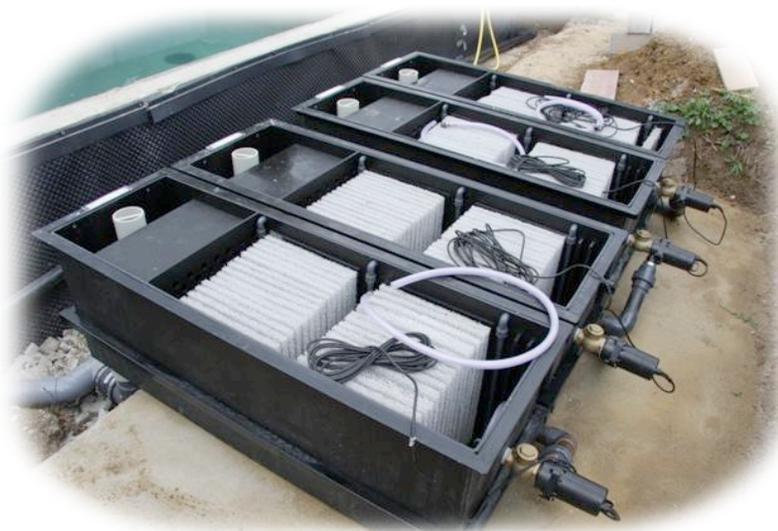
La maintenance est aussi très facilité, il suffit d'enlever un PVC 110 pour purger en quelques secondes le contenu du filtre dont les eaux seront évacuées par un autre PVC du même diamètre. Lors de la maintenance, cela provoque une « vague » qui nettoie tout en quelques secondes sans qu'aucune autre manipulation ne soit nécessaire.
