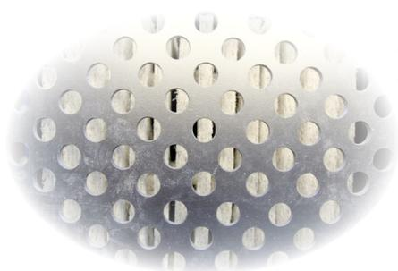
Après, il y a des trous de 3cm de diamètre à la fin des chambres qui assurent un passage de l'eau de façon optimisée sur toute la longueur du filtre.
